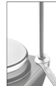
Hinweis: Beim Verwenden von Badbefestigungsteilen mit einem Durchmesser von über 180 mm ist eine Stützstange mit einer Verlängerung zu verwenden (siehe „Zubehör“).
