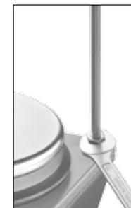
注意：对于直径超过 180 mm 的容器，请将支杆结合延伸支杆使用(见“选配件”)。
