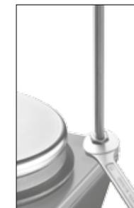
Note: Lors de l'utilisation de fixations pour le bain d'un diamètre supérieur à 180 mm, veuillez utiliser une tige de support avec une extension. (Voir « **Accessoires** »)
