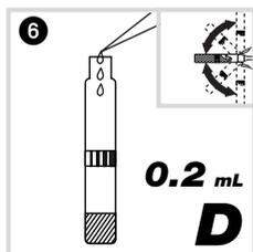
**0.2 mL** Lösung **D** (LCK 138/238/338 D) **langsam** pipettieren.
